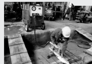
3 Оборудование для преднапряжения арматуры
